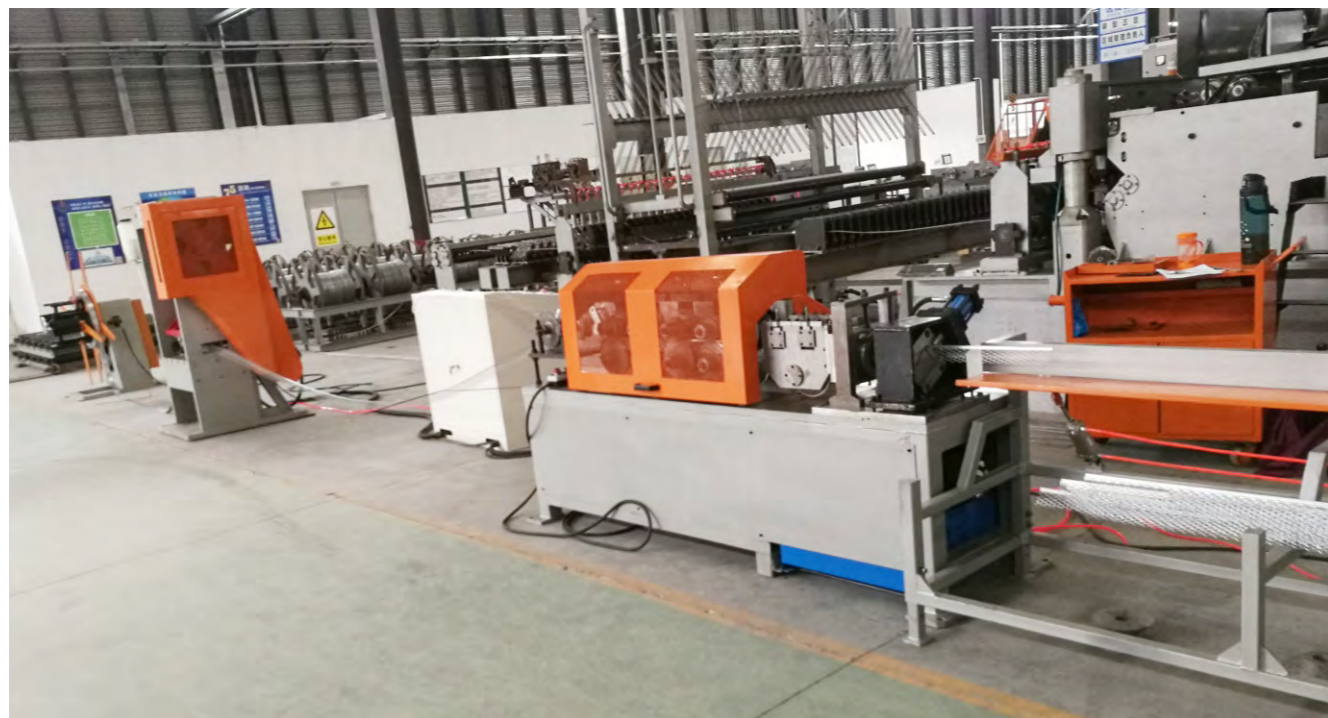
整条护角生产线包含5个部分：开料架，冲床，控制柜，成型，收料台
